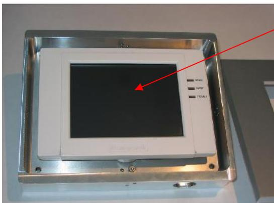
Das Original-Bedienteil 012577 wird genauso wie auch auf einer Wand auf die Befestigungsplatte eingehängt.
